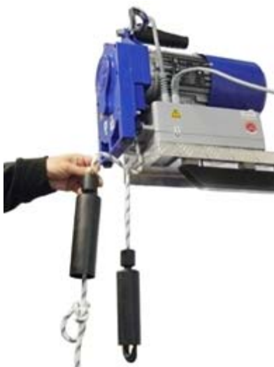
Abbildung 13: Montage Seilfixierung bei einer G-smartrac 150 vario
